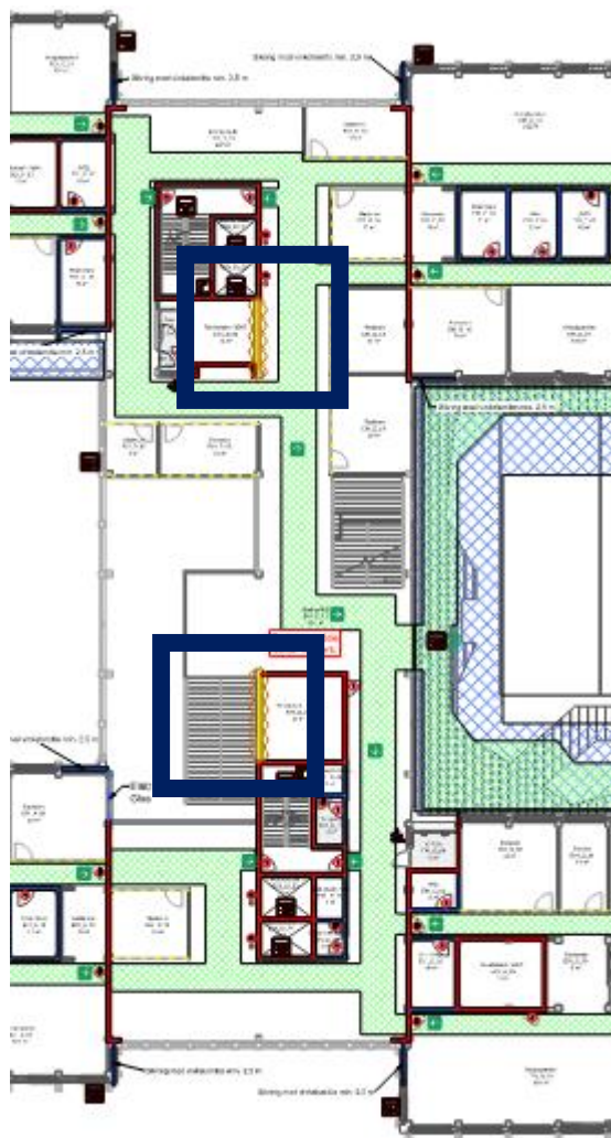
Figur 3-1 Markering af CLT-vægge i område H
